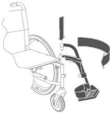
Abb. 5: Einsetzen der Beinstützen
