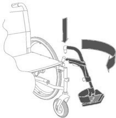
Abb. 5: Einsetzen der Beinstützen
