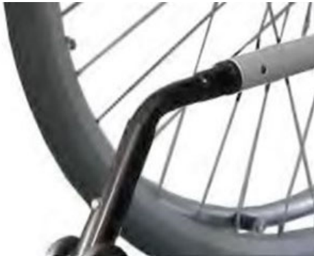
Abb. 19: Montage der Antikippstützen
