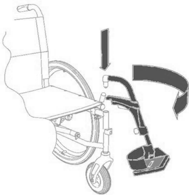
Abb. 4: Einsetzen der Beinstützen
