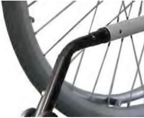
Abb. 19: Montage der Antikippstützen
