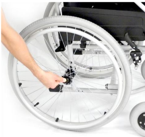
Photo 7 : démontage de la roue arrière
