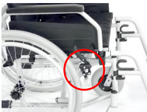
Photo 16 : pas de freinage
