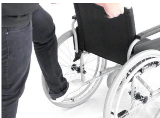
Photo 18 : utilisation de l'aide au basculement
