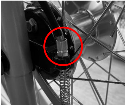
Photo 13 : vis de réglage du frein à tambour
