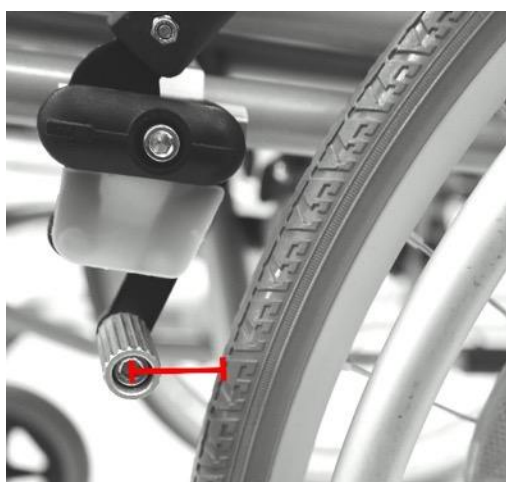
Photo 11 : distance de réglage du frein
