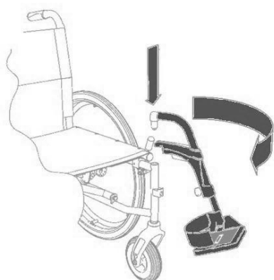
Photo 5 : mise en place des appuie-jambes
