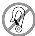
Photo 2 : marquage signifiant l'interdiction de l'utilisation dans les véhicules
