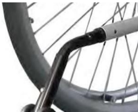
Photo 19 : montage des supports anti-bascule
