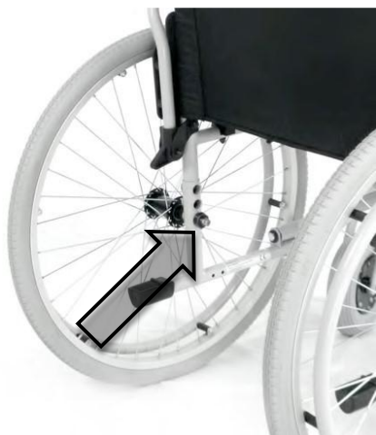
Photo 8 : réglage de la hauteur de la roue arrière
