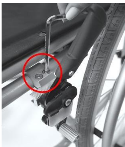
Photo 10 : réglage des freins
