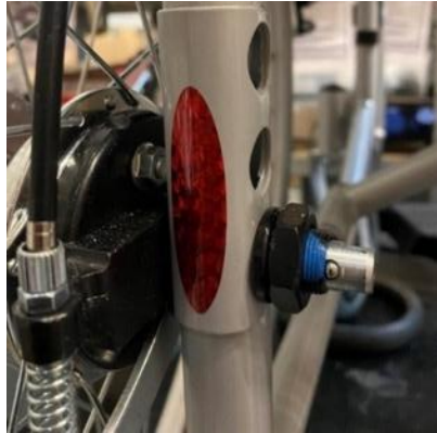
Photo 3 : rétrorélecteur du cadre arrière
