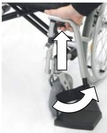
Photo 14 : démontage des appuie-pieds
