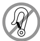
Photo 2 : marquage signifiant l'interdiction de l'utilisation dans les véhicules
