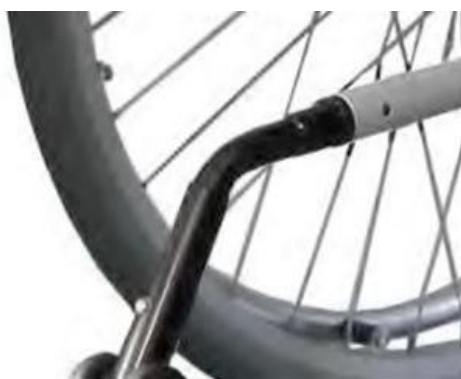
Photo 19 : montage des supports anti-basculé
