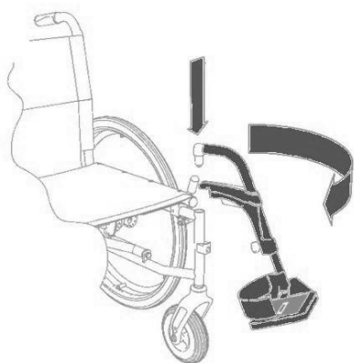
Photo 5 : mise en place des appuie-jambes
