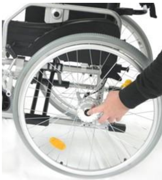
Photo 7 : démontage de la roue arrière
