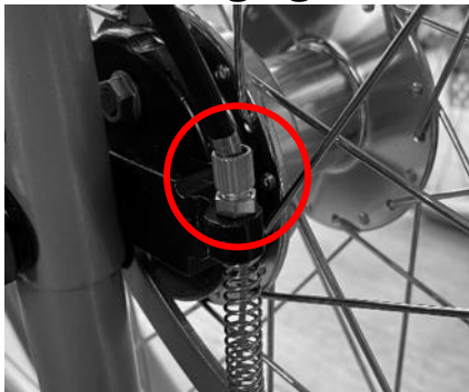
Photo 13 : vis de réglage du frein à tambour
