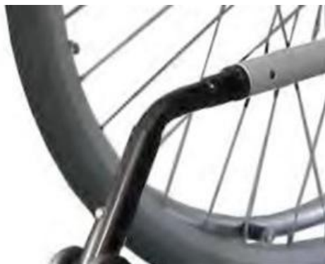
Photo 19 : montage des supports anti-bascule
