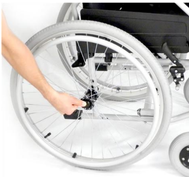
Fig. 7: Smontaggio ruota posteriore
