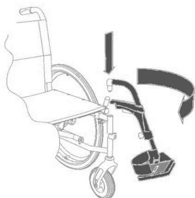
Fig. 5: Montaggio dei poggigambe
