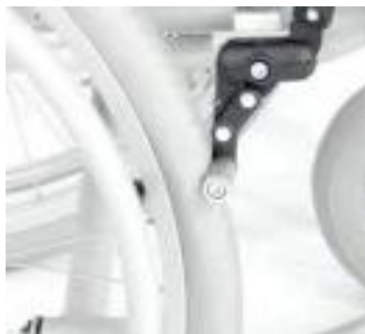
Fig. 12: Freno di stazionamento inserito
