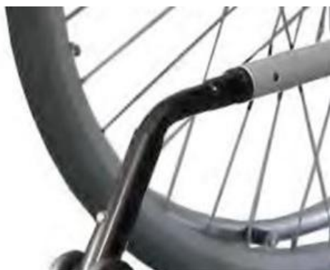
Fig. 19: Montaggio dei dispositivi antiribaltamento
