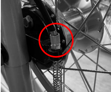
Fig. 13: Vite di regolazione freno a tamburo
