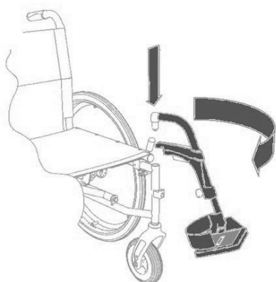
Fig. 5: Montaggio dei poggiamambe
