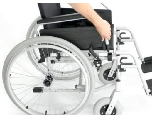
Fig. 15: Sollevamento delle fiancate
