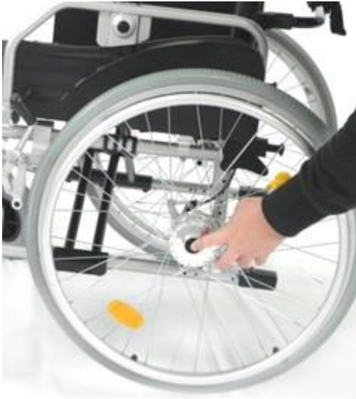
Fig. 6: Smontaggio ruota posteriore
