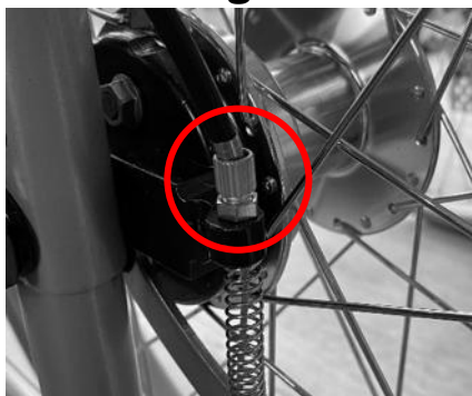
Fig. 13: Vite di regolazione freno a tamburo
