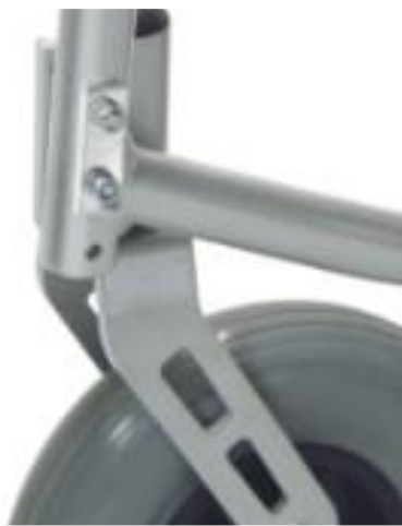
Fig. 8: Regolazione in altezza ruota anteriore
