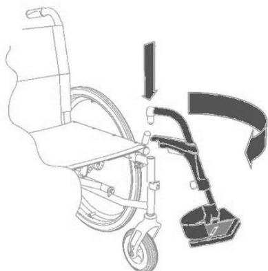
Fig. 4: Montaggio dei poggiamambe
