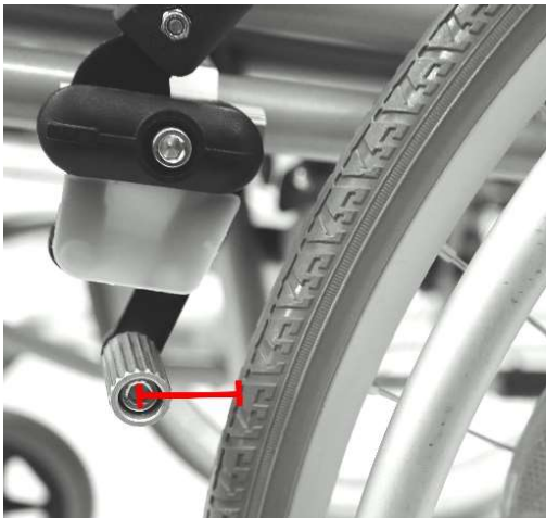
Abb. 11: Abstand der Bremseinstellung
