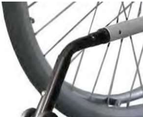
Abb. 19: Montage der Antikippstützen
