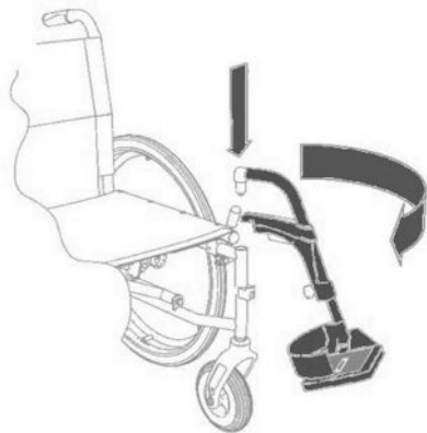
Abb. 5: Einsetzen der Beinstützen
