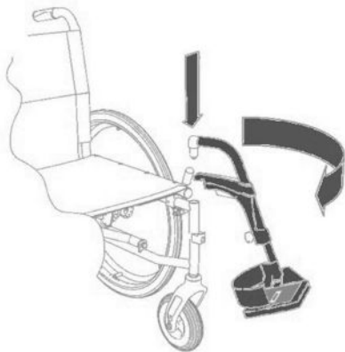
Abb. 5: Einsetzen der Beinstützen
