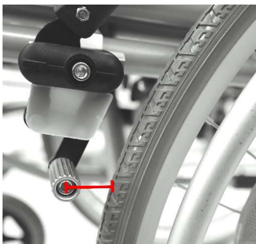
Abb. 11: Abstand der Bremseinstellung
