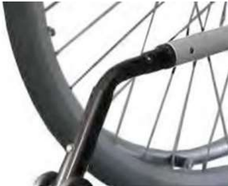
Abb. 19: Montage der Antikippstützen
