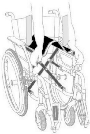
Abb. 4: Auffalten des Rollstuhls
