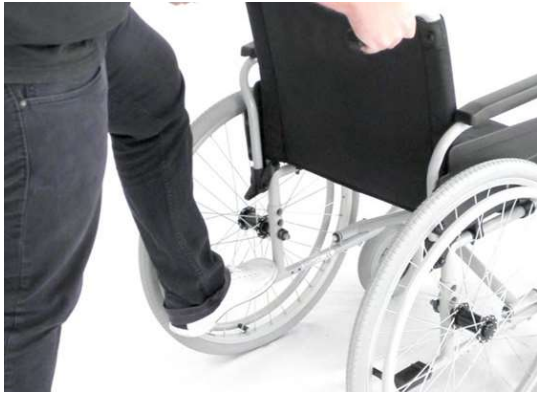
Abb. 18: Nutzung der Kipphilfe
