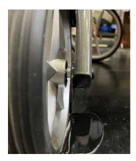
Serrez l'écrou de la roue arrière avec un **couple de serrage de 5 Nm**.
