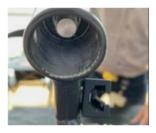
Vissez l'écrou. Dévissez d'abord le verrouillage à vis, puis serrez l'écrou avec un **couple de serrage de 5 Nm**.
