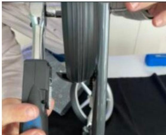
Prima di inserire le calotte di copertura, verificare il corretto posizionamento dei dadi e il corretto movimento delle ruote.
