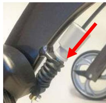
2. Tendere il cavo Bowden ruotandolo in senso antiorario o allentarlo ruotandolo in senso orario.
