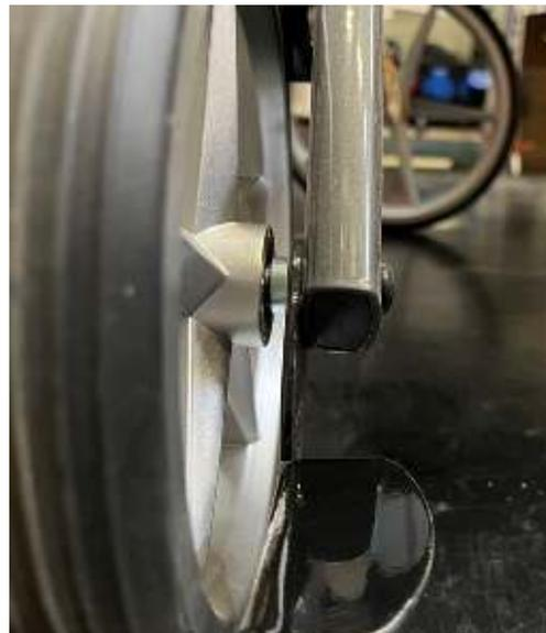
Serrare il dado della ruota posteriore con una **coppia di serraggio di 5 Nm**.
